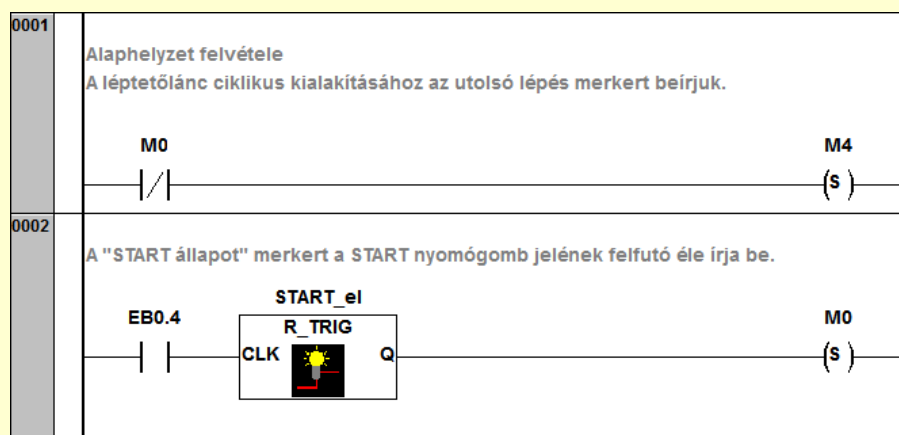
3.23. ábra: Az alaphelyzet felvétele és a START nyomógomb lekezelése (Forrás: saját szerkesztés)
